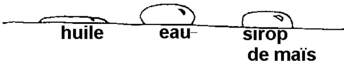
On observe que l'eau et le sirop ont des forces de cohésion supérieures à celle de l'huile car capables de résister à la gravité. Ajoutez encore de l'eau pour grossir la goutte. Plus on en ajoute, plus la gravité l'aplatit.
